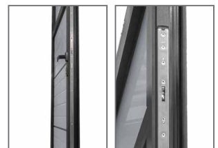
Serrure 3 points pour cadre de porte hauteur : 2390–2600 mm (poignée à min. 1200 mm du sol) Serrure 3 points pour cadre de porte hauteur : 2060–2389 mm (crémone intégrée incluse) (poignée à min. 1050 mm du sol)
