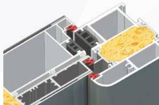
Per garantire un perfetto isolamento il portoncino è dotato di tre guarnizioni continue di tenuta: 1 sul telaio e 2 sull'anta.
