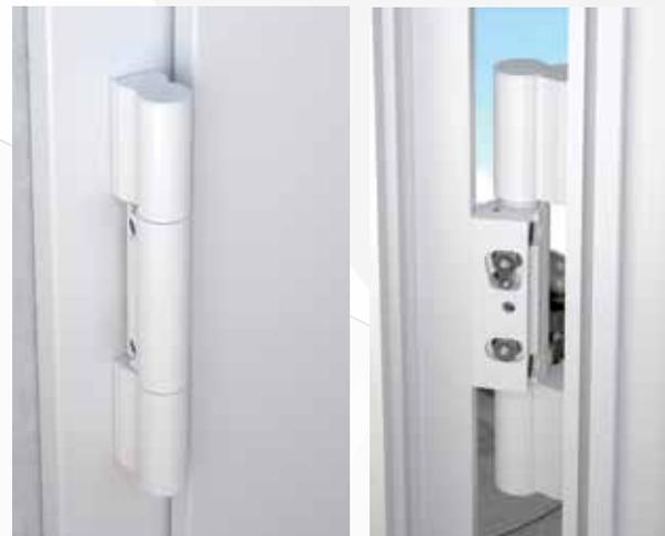
Ogni portoncino è dotato di tre cerniere, in grado di sostenere fino a 160kg. Ogni cerniera dispone di due alloggiamenti, che vengono fissati con l'ausilio di viti auto-foranti nel profilo rinforzato del telaio, con lunghi perni per distribuire la forza. In questo modo non si va a toccare la guarnizione, mantenendo la massima performance termica. Le cerniere sono regolabili in tre direzioni, per permettere registrazioni semplici e veloci a garanzia di una perfetta chiusura.
