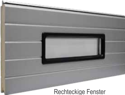
Rechteckige Fenster Schwarzer Kunststoffrahmen Doppel-Acrylverglasung Größe 640 x 336 mm
